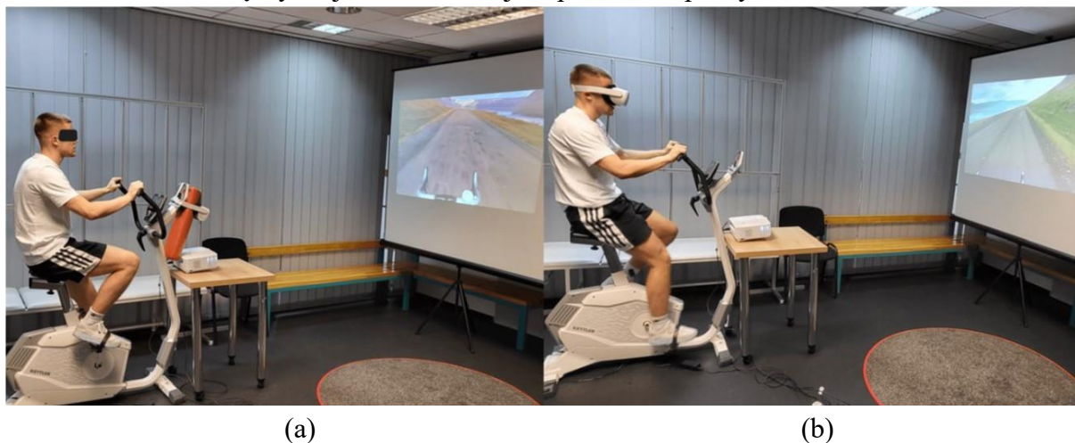
Ryc. 13. Stanowisko badawcze: (a) „Sesja 1” – jazda na rowerze stacjonarnym w nIVR; (b) „Sesja 2” – jazda na rowerze stacjonarnym w IVR
