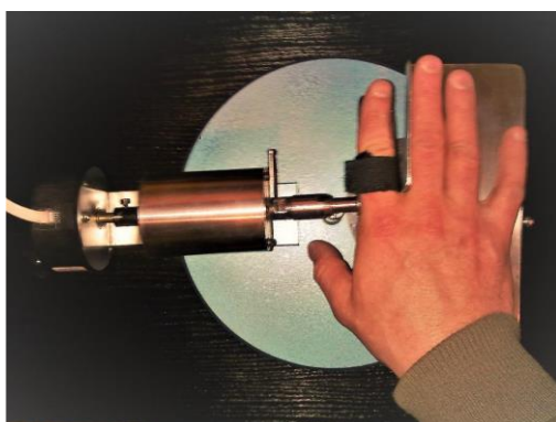
Ryc. 20. Ułożenie ręki na manipulandum w położeniu początkowym
