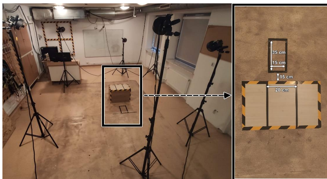
Rycina 10. Ustawienie kamer oraz stanowiska do lądowania jedno nogę po zeskoku pionowym.
