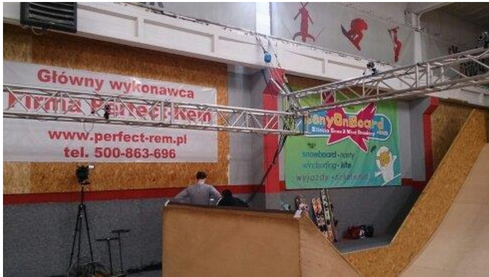
Rysunek 18. Widok stanowiska pomiarowego. Na pierwszym planie krawędź rampy z markerami, kratownica z kamerami 'Bonita' oraz jedna z kamer systemu video (widoczna po lewej stronie zdjęcia).
