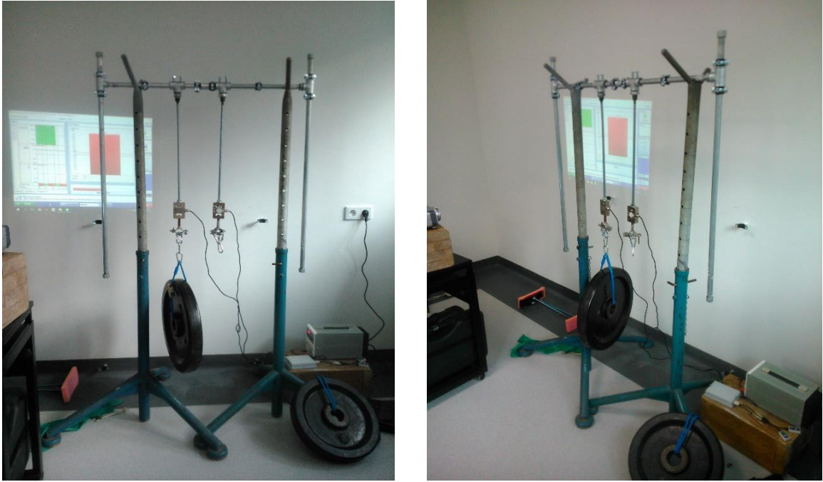
Ryc. 19 Sprawdzenie powtarzalności pomiarów obu czujników siły zaimplementowanych w układzie „DIATOS”
