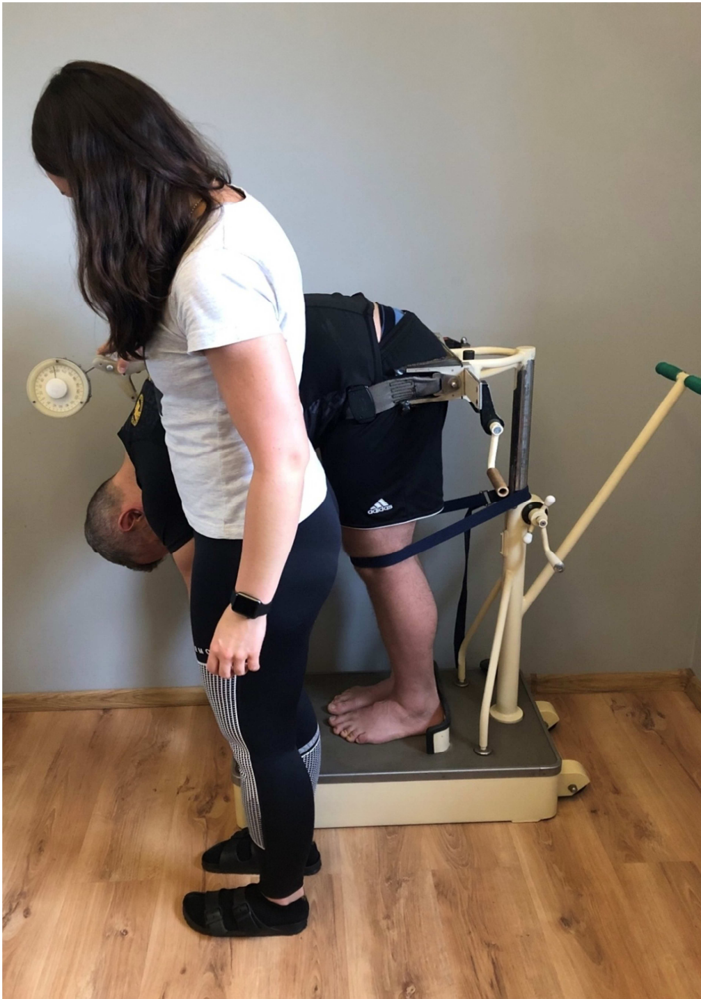
Fot. 4. Przyrząd do pomiarów ruchomości kręgosłupa pomysłu Ślężyńskiego: pomiar skłonu w przód w płaszczyźnie strzałkowej kątomierzem grawitacyjnym z płozami
