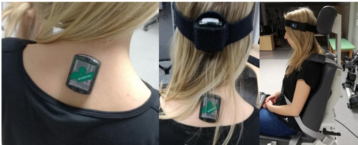
Ryc. 1. Rozmieszczenie czujników akcelerometrycznych Noraxon Myo Motion 18 w czasie pomiarów ruchomości odcinka szyjnego kręgosłupa (źródło własne).
