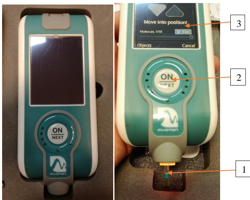
Ryc. 3. Miometr Myoton Pro: 1 – końcówka pomiarowa, 2 – przycisk włączenia urządzenia i wyboru funkcji, 3 – ekran dotykowy (źródło własne).
