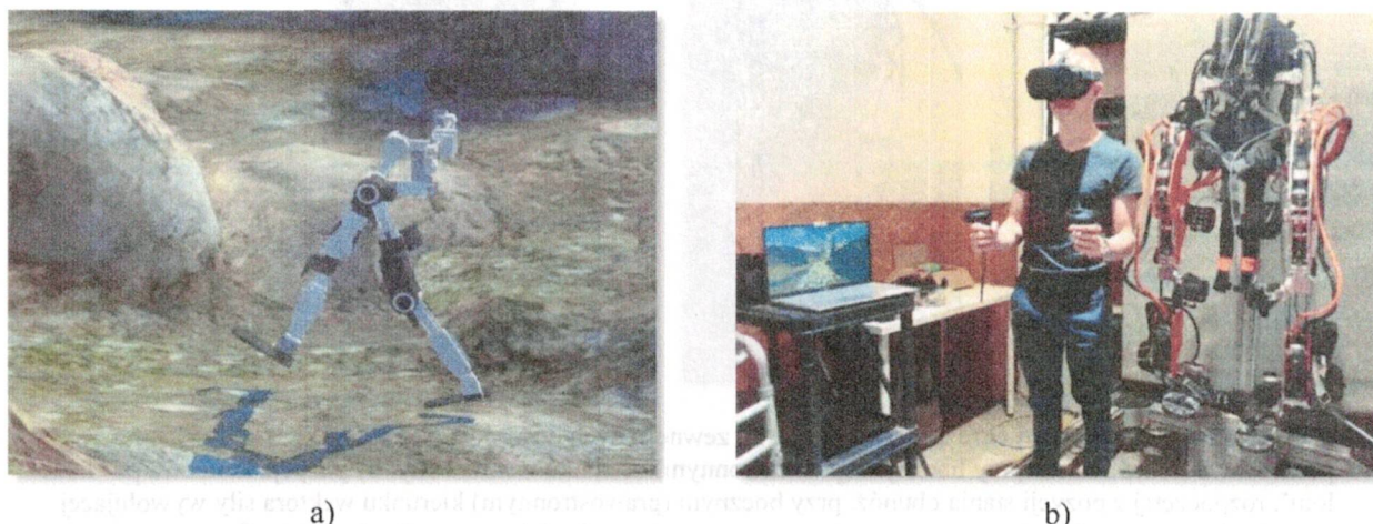
Rycina 7. Działanie systemu wirtualnej rzeczywistości: a) wirtualne otoczenie imitujące środowisko górskie z poruszającym się egzoszkieletem, b) testowanie systemu wirtualnej rzeczywistości z udziałem członków zespołu projektowego.
