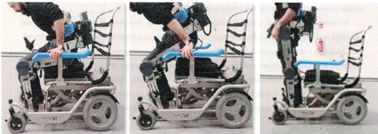
Rycina 9. Testy zmiany pozycji z siadu do stania w opracowanym rozwiązaniu hybrydowym egzoszkiet DreamMotion P2 – platforma jezdna.
