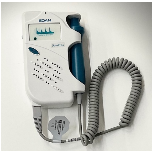
Rycina 4. Przenośny ultrasonograficzny Doppler naczyniowy SonoTrax (materiał własny).
